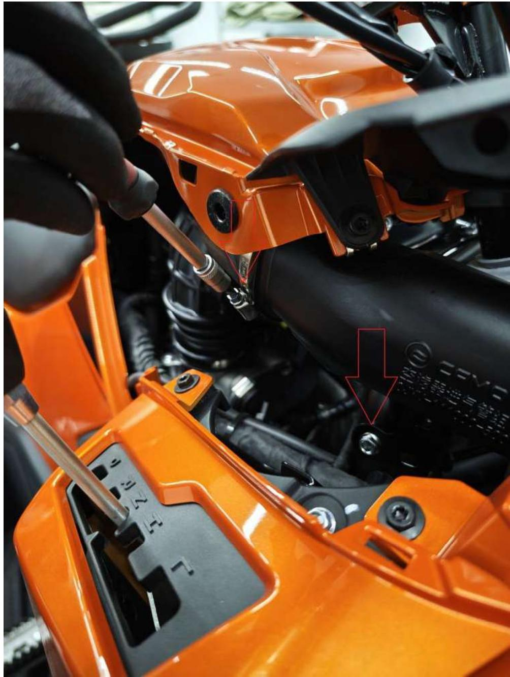
Step 4: Šitikiname, kad ant filtro dėžės yra sandarinimo žiedas ir uždedame adapterį tais pačiais tvirtinimo elementais (labai svarbu neperveržti sąvaržos ir pasireguliuoti tvirtinimo laikiklij)
